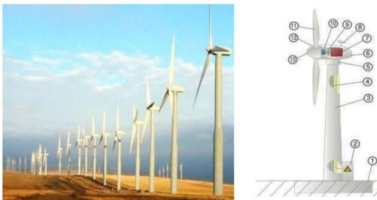
7.5-rasm. Sanoatda ishlab chiqariladigan shamol energetik qurilmalarining joylashishi va tuzilishi.
