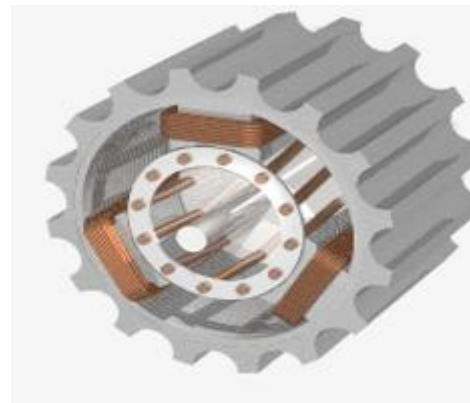
6.3-rasm. Statorga izolyatsiyalangan simning o'ralishi
