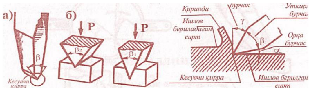
9-rasm. Kesuvchi qirra va sirtlar
