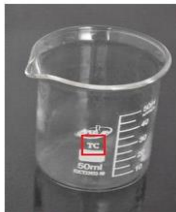
3-rasm. Kimyoviy stakanlar: a - burunchali; b – kalibrovka qilingan.
