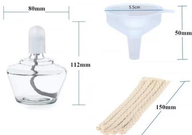
I.2-rasm. Spirt lampasi tarkibiy qismlari, ularning o'lchamlari, gaz gorelkasi
