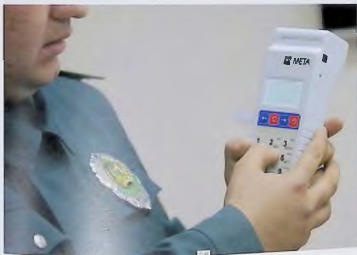
«Meta АКПБ-01» русумли автомобилотранспорт воситаси ҳайдовчиларининг иниқлиқ даражасини аниқловчи қурilmazkir
