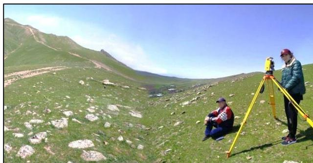
Рис. 1. Тахеометрическая съемка местности
