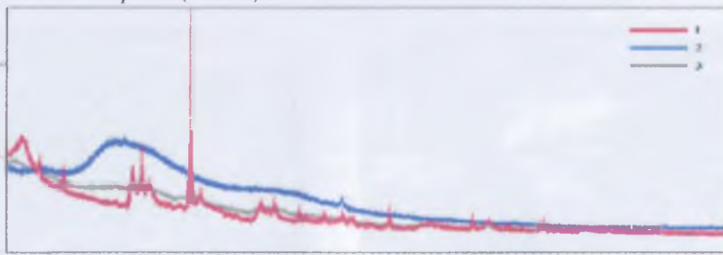
6-rasm. PBG markali bentonit gilmoiyasi (1), poliakril kislotasi asosidagi gidrogel (2) hamda ular asosida olingan polimer kompozitsiyaning (3) difraktogrammalari
